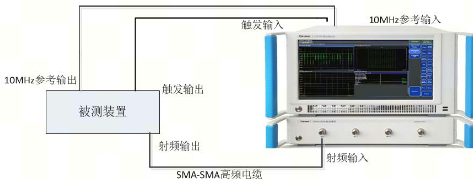
图 4.12 被测设备与基站测试仪连接图
