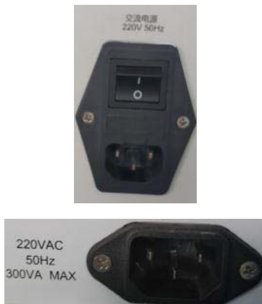
图 3.1 5252D 5G 基站测试仪后面板电源插座
