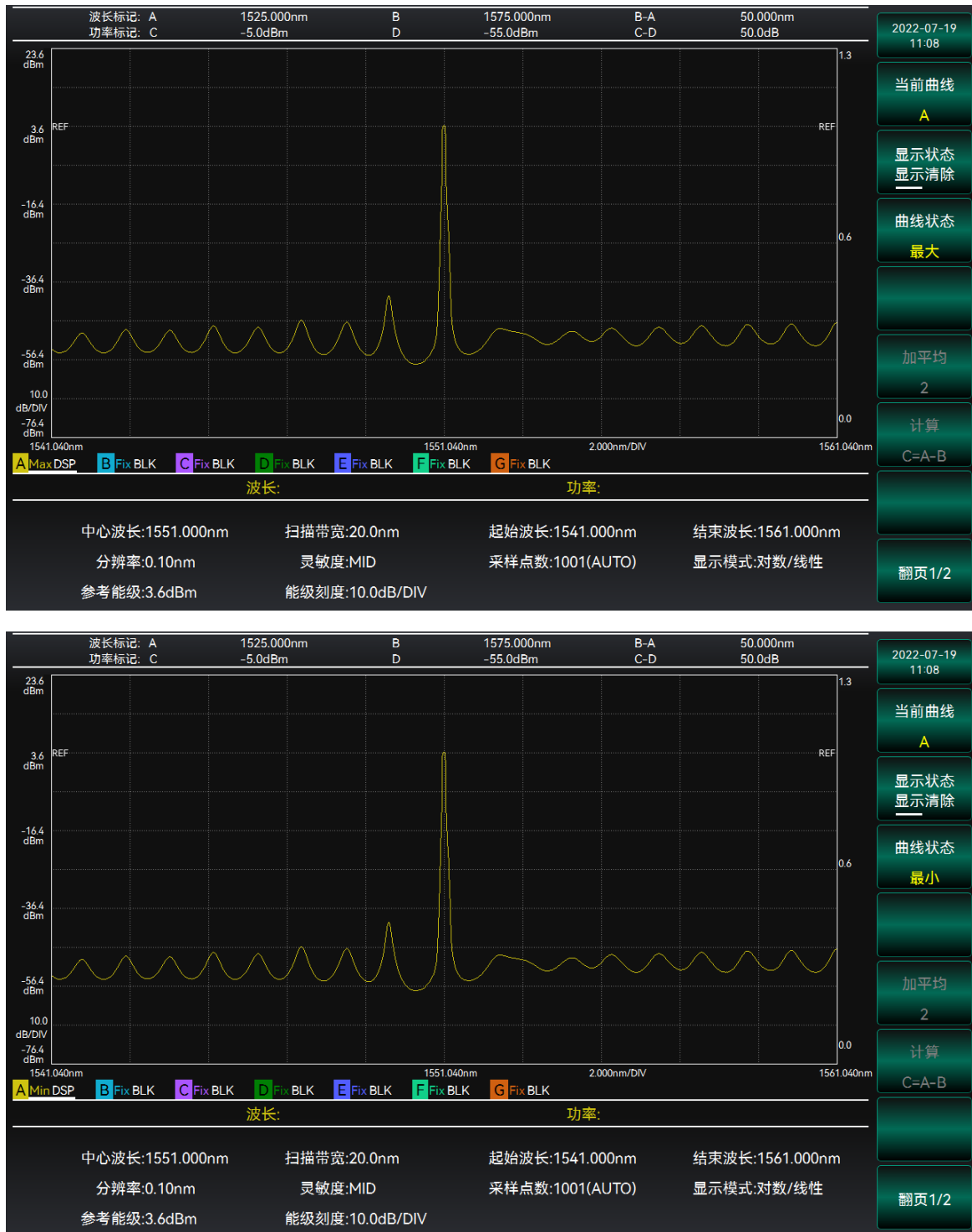
图 3-32 曲线保持条件示意图
