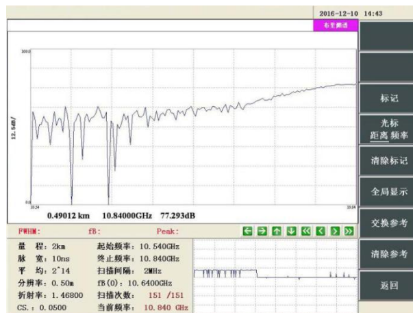
图 9-4 初始、终止频率选择偏左的频谱
