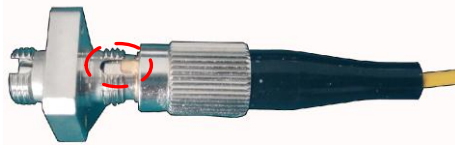
图 D-10 FC/UPC 接口凸起与法兰盘接口凹陷处对齐
