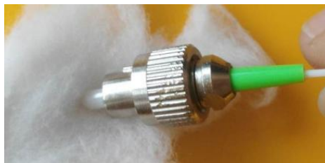
图 F-12 酒精棉擦拭光纤接头
