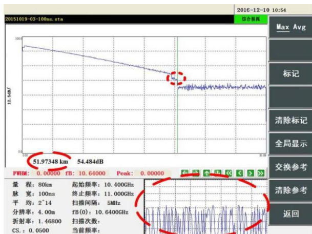
图 8-14 越过某点后布里渊谱消失
