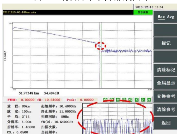
图 G-3 越过某一点后布里渊谱消失
