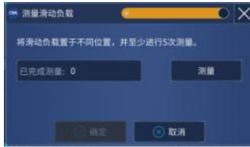
图 7.12 校准件测量(滑动负载)界面
