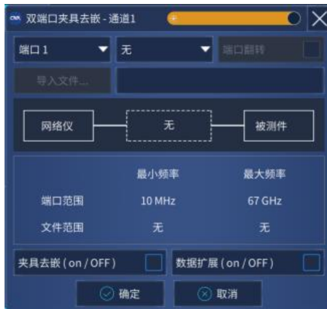
图 7.40 双端口夹具去嵌界面
