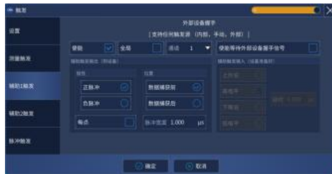
图 4.25 辅助 1/2 触发对话框
