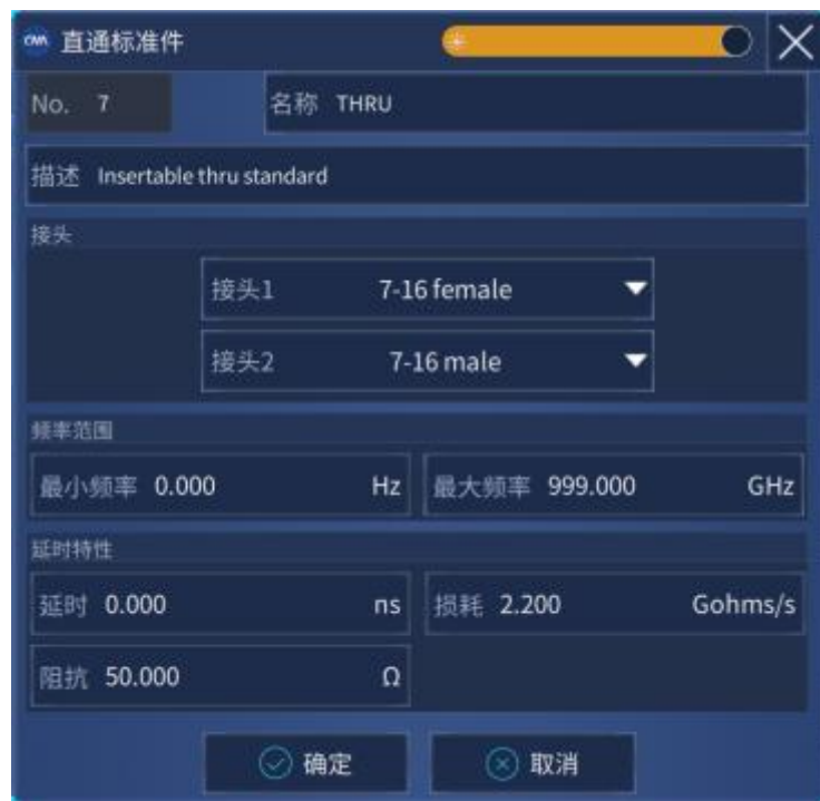
图 7.32 直通/空气线对话框
