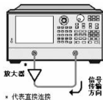
图 8.22 反向隔离测量连接
