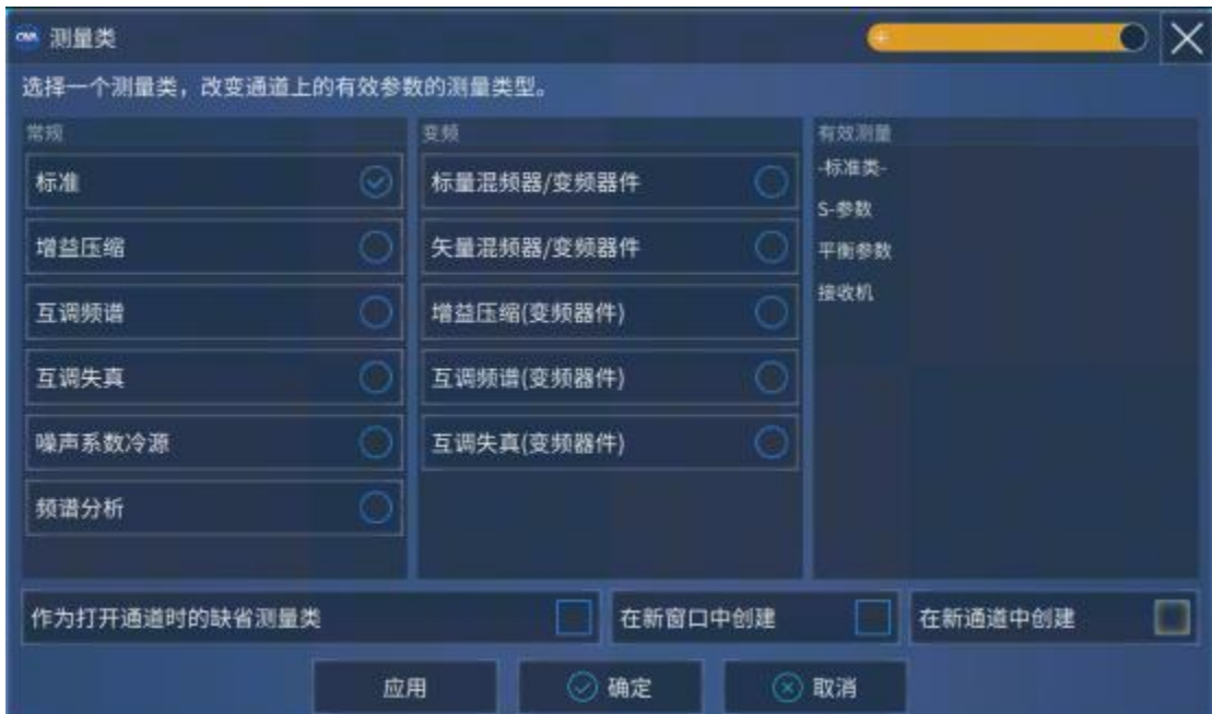
附图 8.21 创建噪声系数测量
