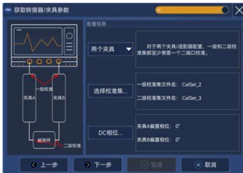
图 7.58 获取转接器/夹具参数界面
