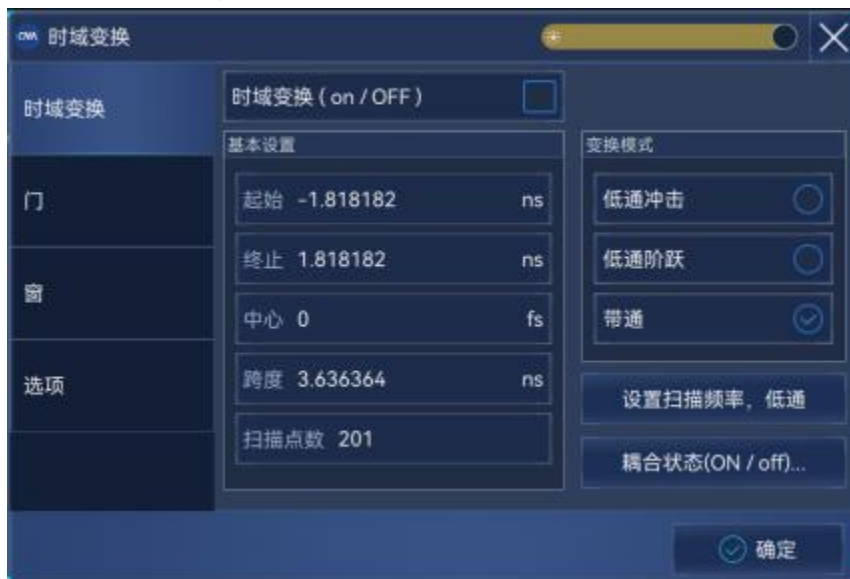
附图 2.29 时域变换方式的设置
