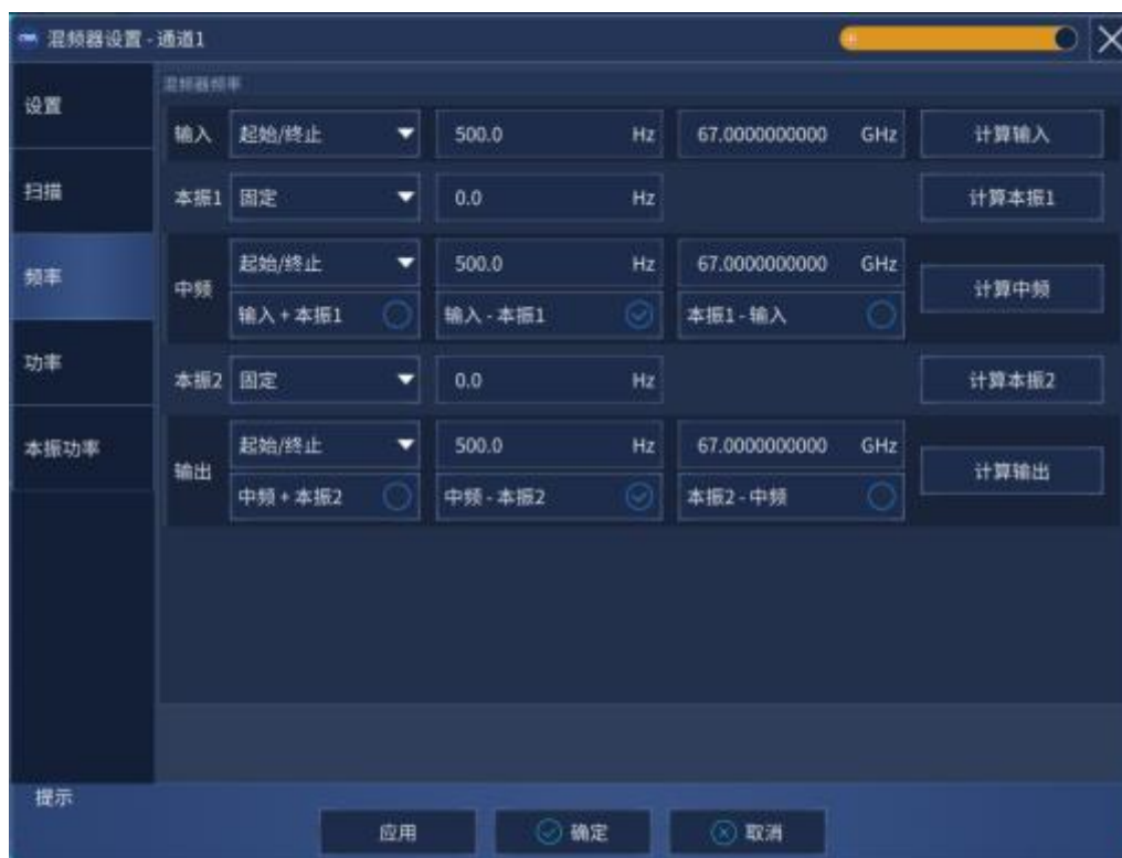
附图 6.7 混频器频率设置对话框
