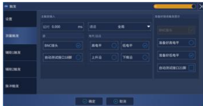
图 4.24 测量触发对话框
