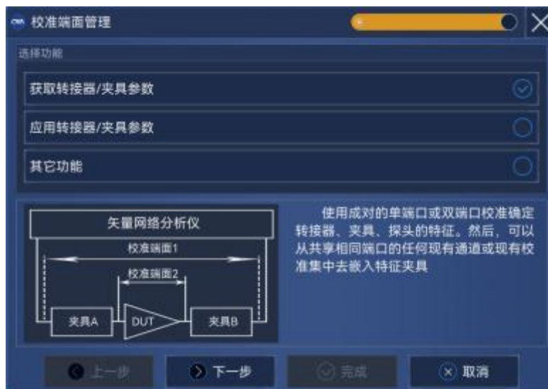
图 7.57 校准端面管理界面
