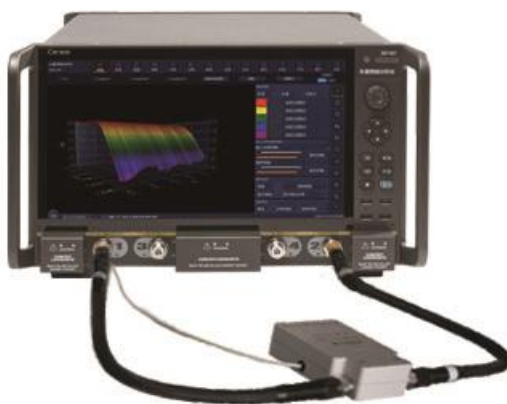
附图 5.11 增益压缩测量连接
