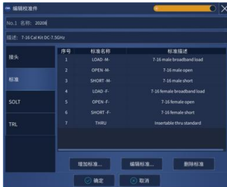
图 7.24 编辑校准件对话框
