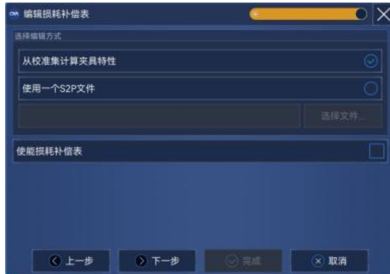
图 7.72 编辑损耗补偿表界面
