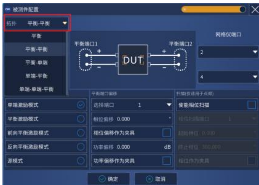
图 4.8 差分平衡 S 参数拓扑设置对话框
