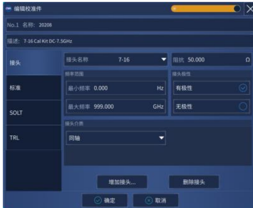
图 7.26 增加或修改连接器对话框
