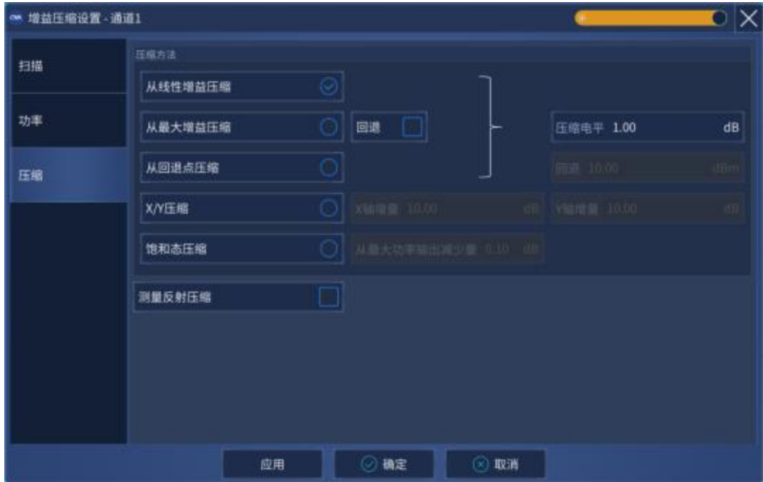
附图5.8 压缩设置对话框
