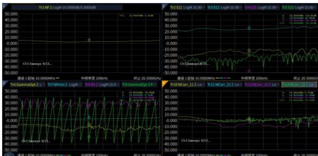
图 2.3 多窗口测量显示
