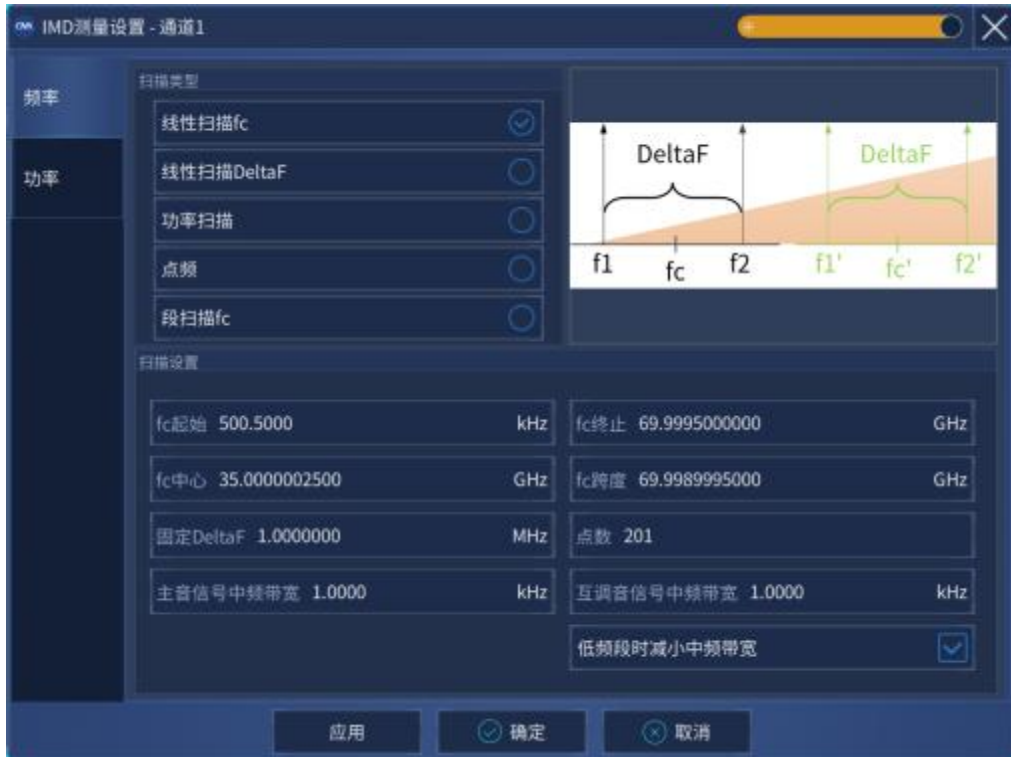
附图 7.5 互调失真频率设置对话框
