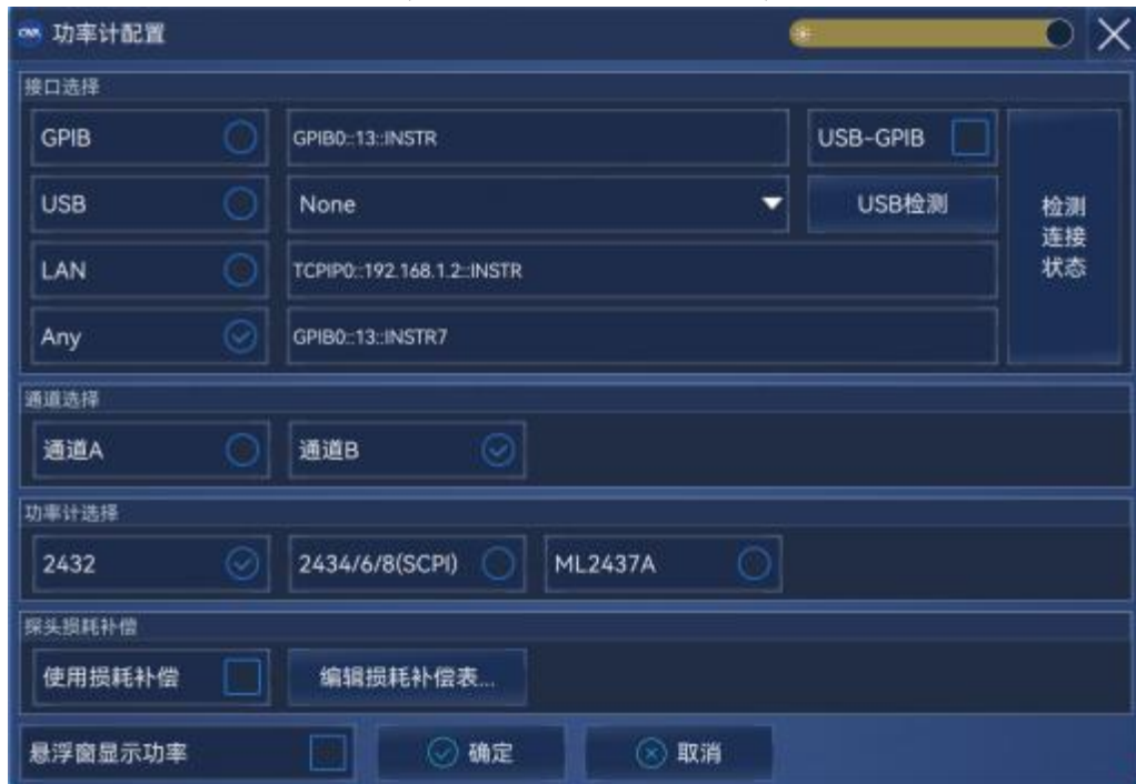
附图 6.15 端口功率校准设置对话框
