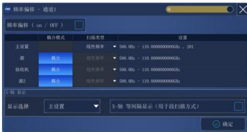
附图 3.1 频偏测量对话框
