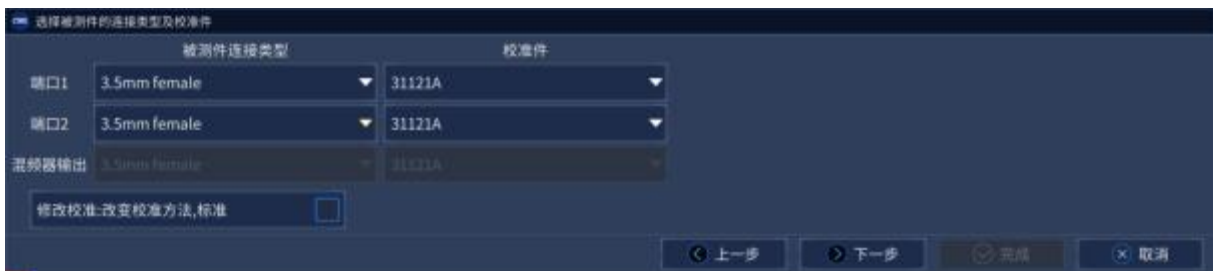
附图 6.23 被测件连接类型和校准
