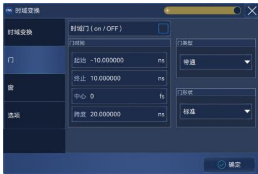
附图 2.26 时域变换测量-设置门
