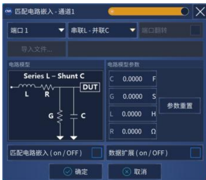
图 7.43 匹配电路类型下拉菜单
