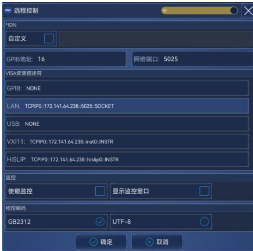
图 9.9 GPIB 接口设置
