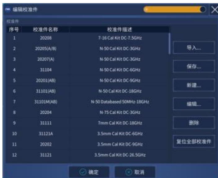
图 7.23 编辑校准件对话框
