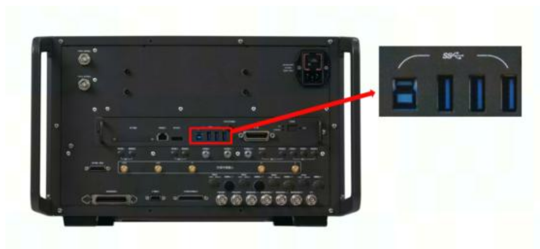
图 9.11 仪器后面板程控用 USB 接口
