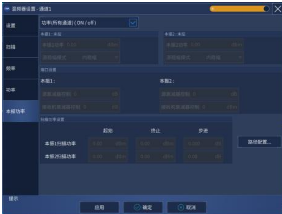
附图 6.10 混频器本振功率设置对话框
