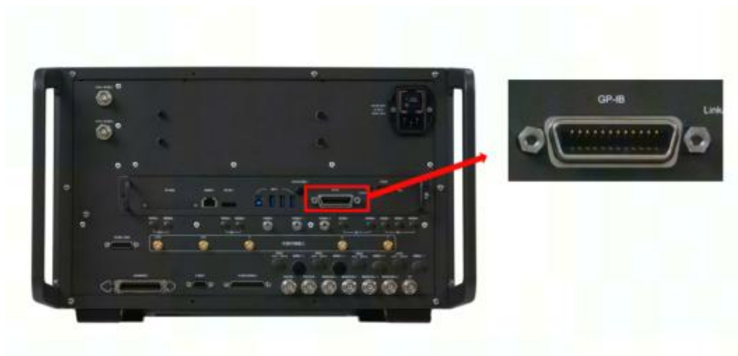
图 9.8 仪器后面板 GPIB 接口
