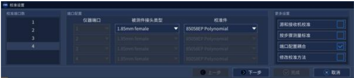
图 7.3 校准设置界面(未连接电子校准件)
