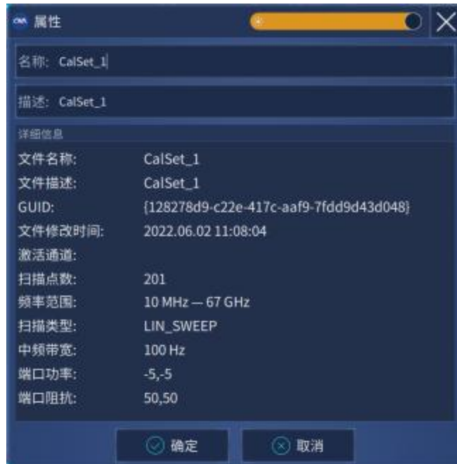
图 7.19 校准集属性对话框
