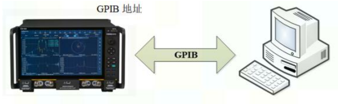
图 9.7 GPIB 接口连接图
