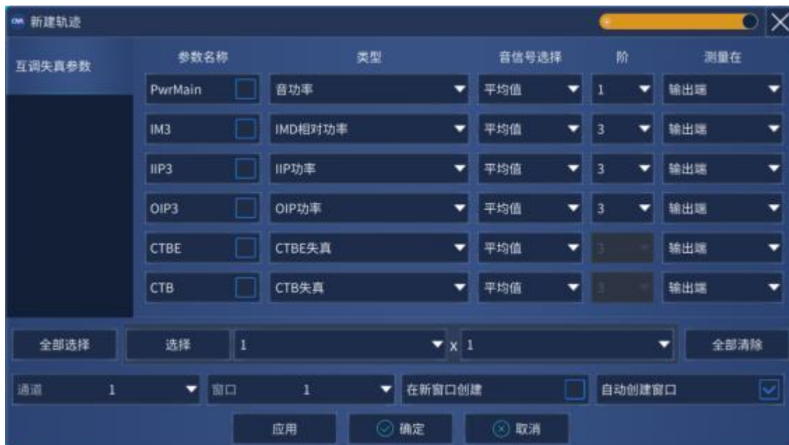
附图 7.8 互调失真测量参数设置
