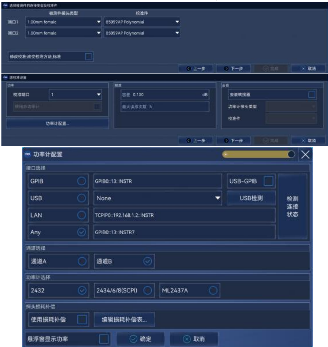
附图 5.9 选择被测件的连接类型和校准件
