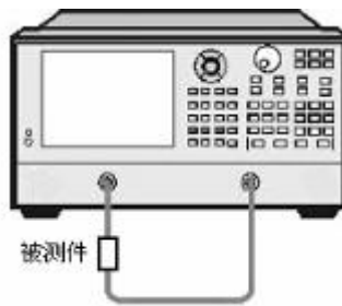
图 8.21 线性相位偏离测量连接
