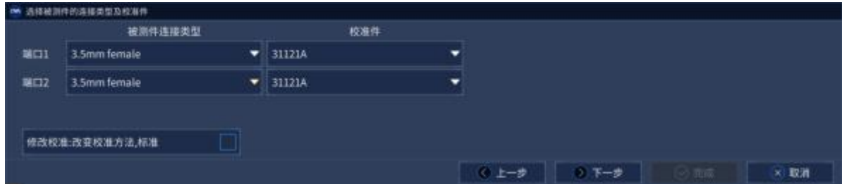
附图 6.13 连接器和校准件
