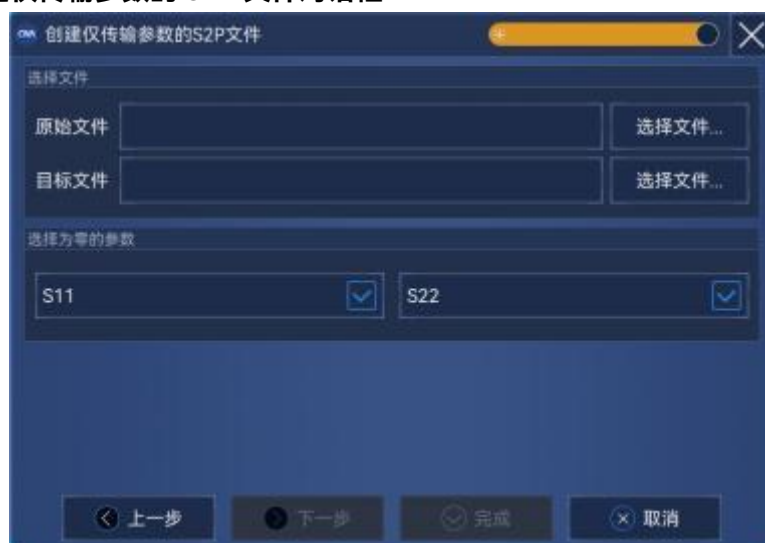
图 7.69 创建仅传输参数的 S2P 文件界面
