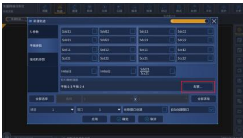
图 4.7 差分平衡 S 参数的轨迹创建
