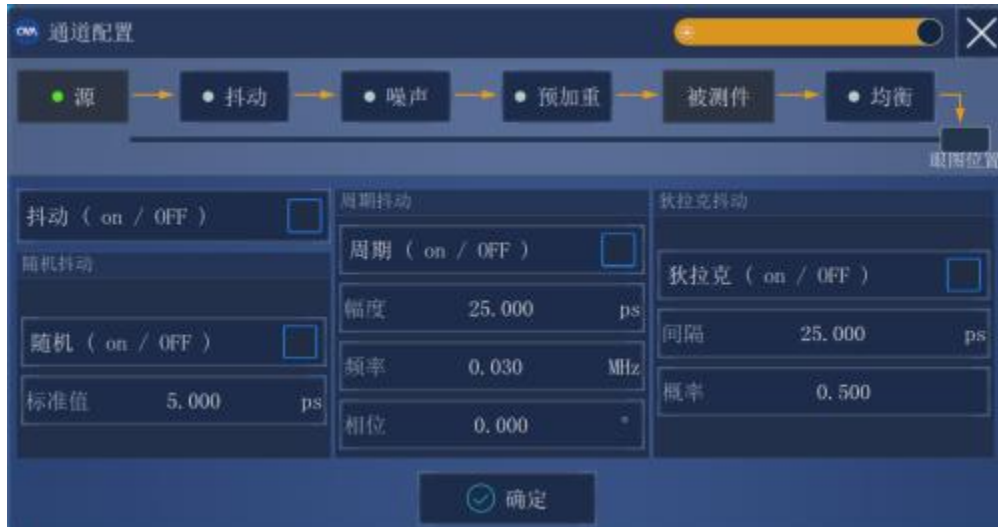
附图9.23 眼图波形高级分析设置
