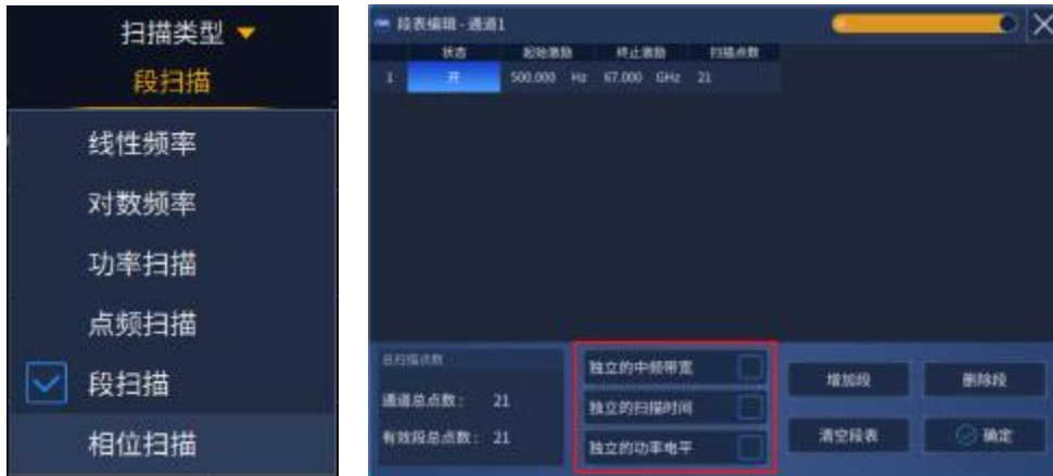
图 4.16 设置段扫描类型
