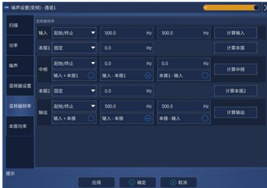
附图 8.26 混频器频率选项卡
