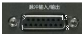
图3.32 脉冲输入/输出连接器
