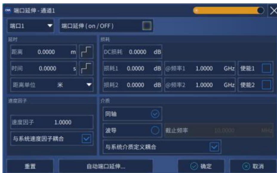
图 7.37 设置端口延伸
