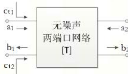
附图 8.6 线性二端口网络噪声波模型
