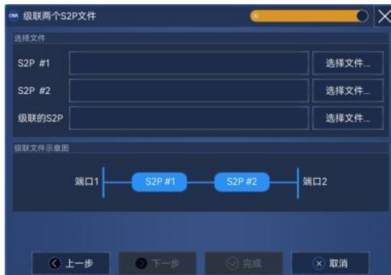
图 7.70 级联两个 S2P 文件界面
