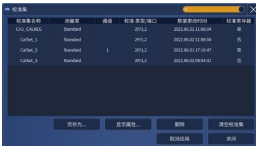
图 7.22 取消应用校准集
