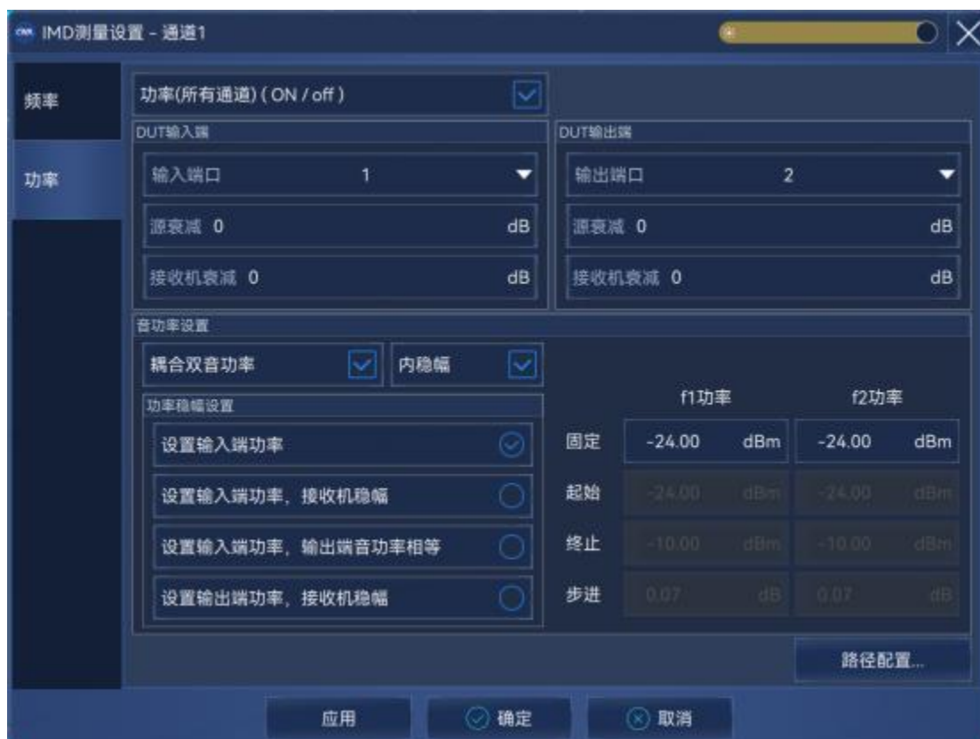
附图 7.6 互调失真功率设置对话框
