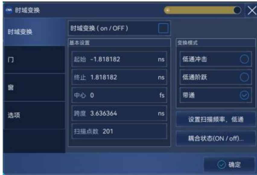
附图 2.24 设置时域变换测量
