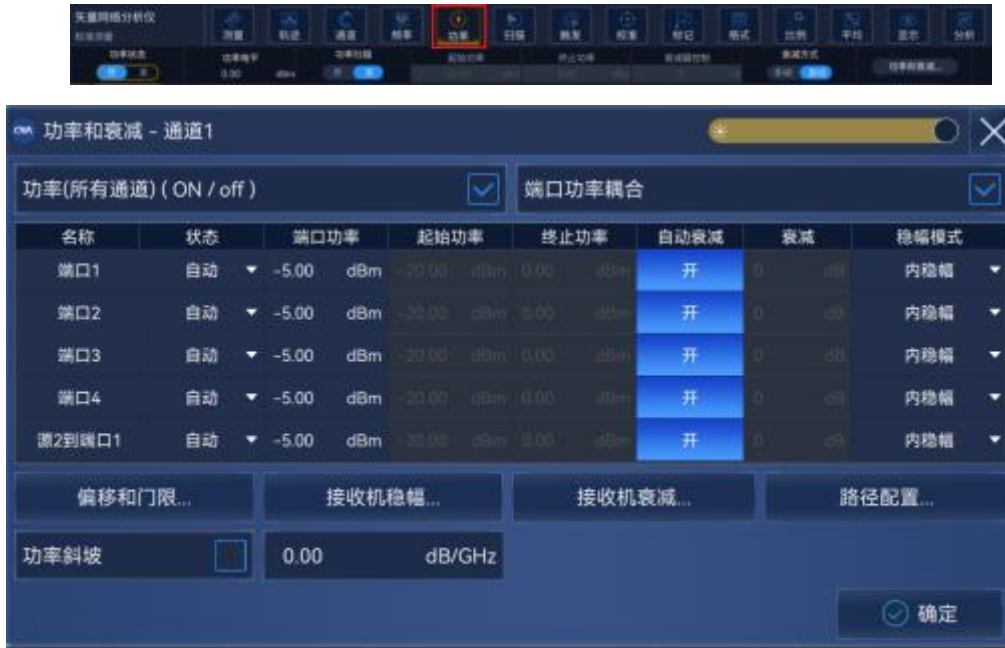
图 4.14 设置功率电平
