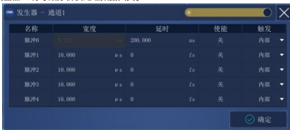
附图 4.13 脉冲发生器设置对话框
