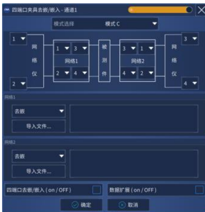
图 7.46 四端口夹具去嵌/嵌入界面
