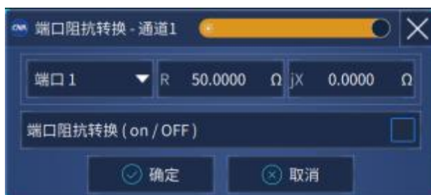
图 7.45 端口阻抗转换界面
