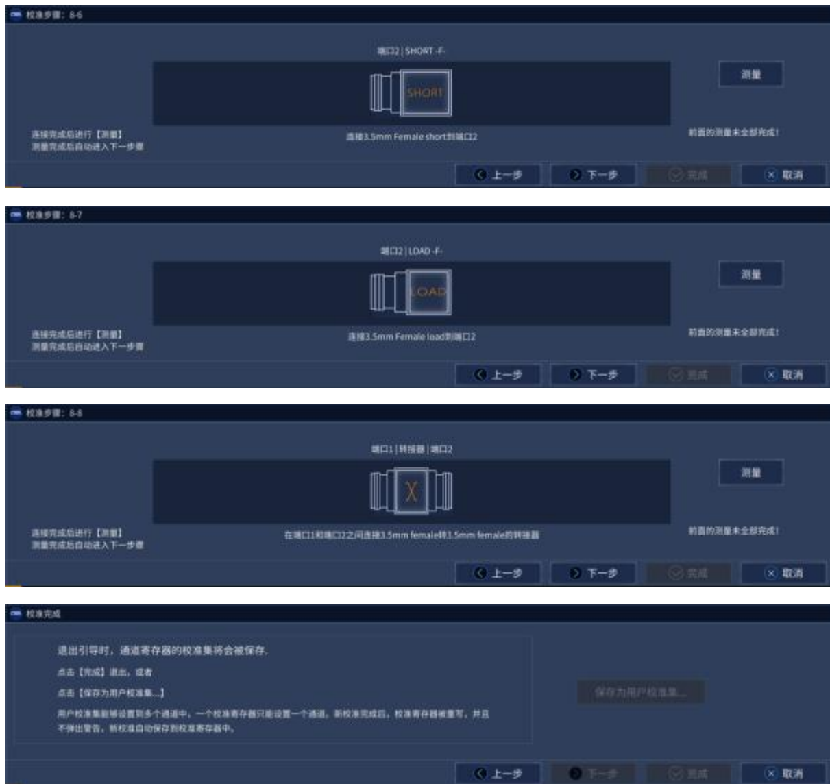
附图 6.16 校准步骤对话框
