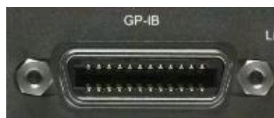
图 3.26 通用接口总线连接器
