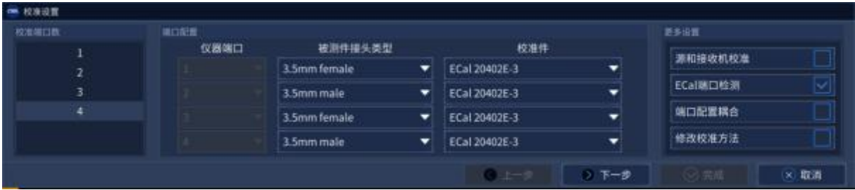
图 7.2 校准设置界面(连接电子校准件)
