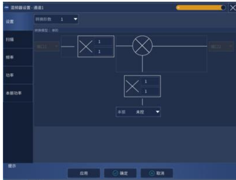
附图 6.21 矢量混频器测量校准对话框
