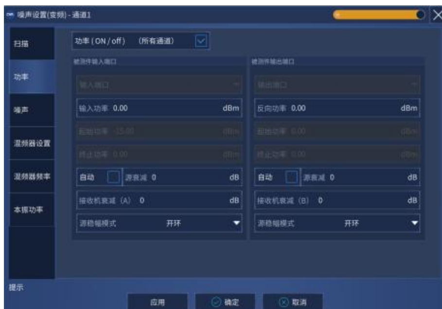
附图 8.23 变频器噪声系数测量功率选项卡
