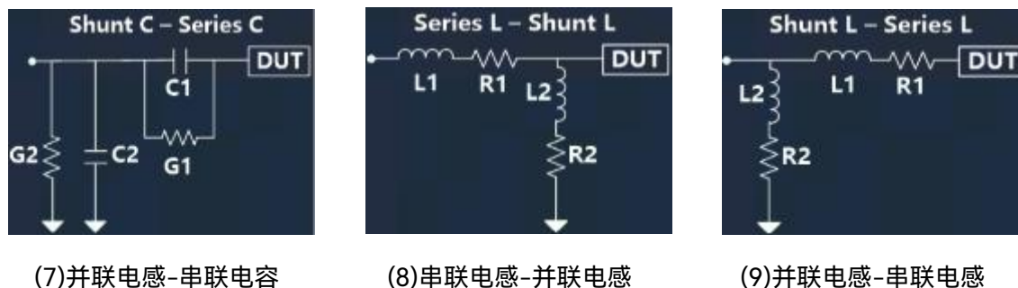
图 7.44 嵌入匹配电路的 9 种电路参数模型
