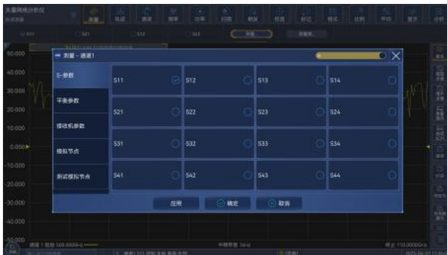
图 4.11 设置当前激活轨迹的 S 参数测量类型
