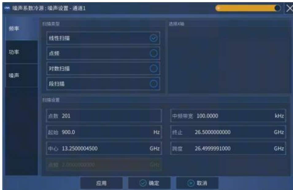
附图 8.22 变频器噪声系数测量频率选项卡
