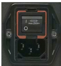
图 3.1 电源插座（下）和电源开关（上）
