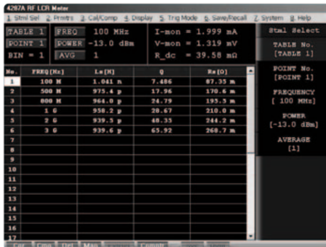
图 2. 在多个测量频率上精确地测量被测器件的阻抗
