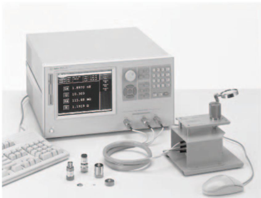
图 9. 完整的阻抗测量解决方案 (图中夹具为 16196A)
